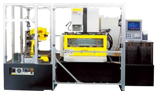
利用机器人的工件装卸单元
