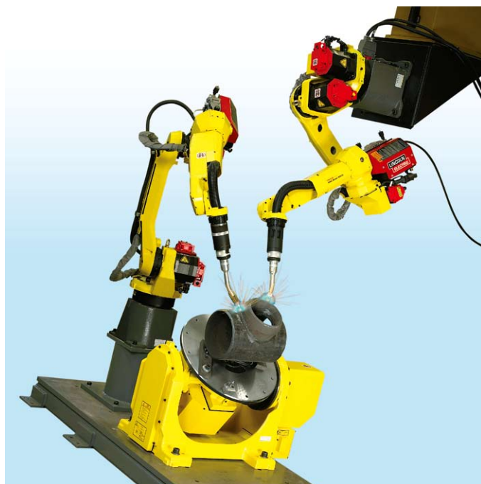
2軸サーボポジションナを活用した 自動車部品のアーク溶接
