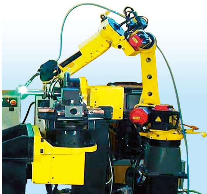
1軸サーボポジションナを活用した アルミ部品のアーク溶接
